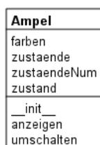
Abbildung 21.1.: Klassendiagramm Ampel
